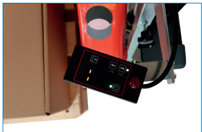
Die Bedienung der Positionskontrolle erfolgt intuitiv über ein Modul, in dem auch der Sensor integriert ist
