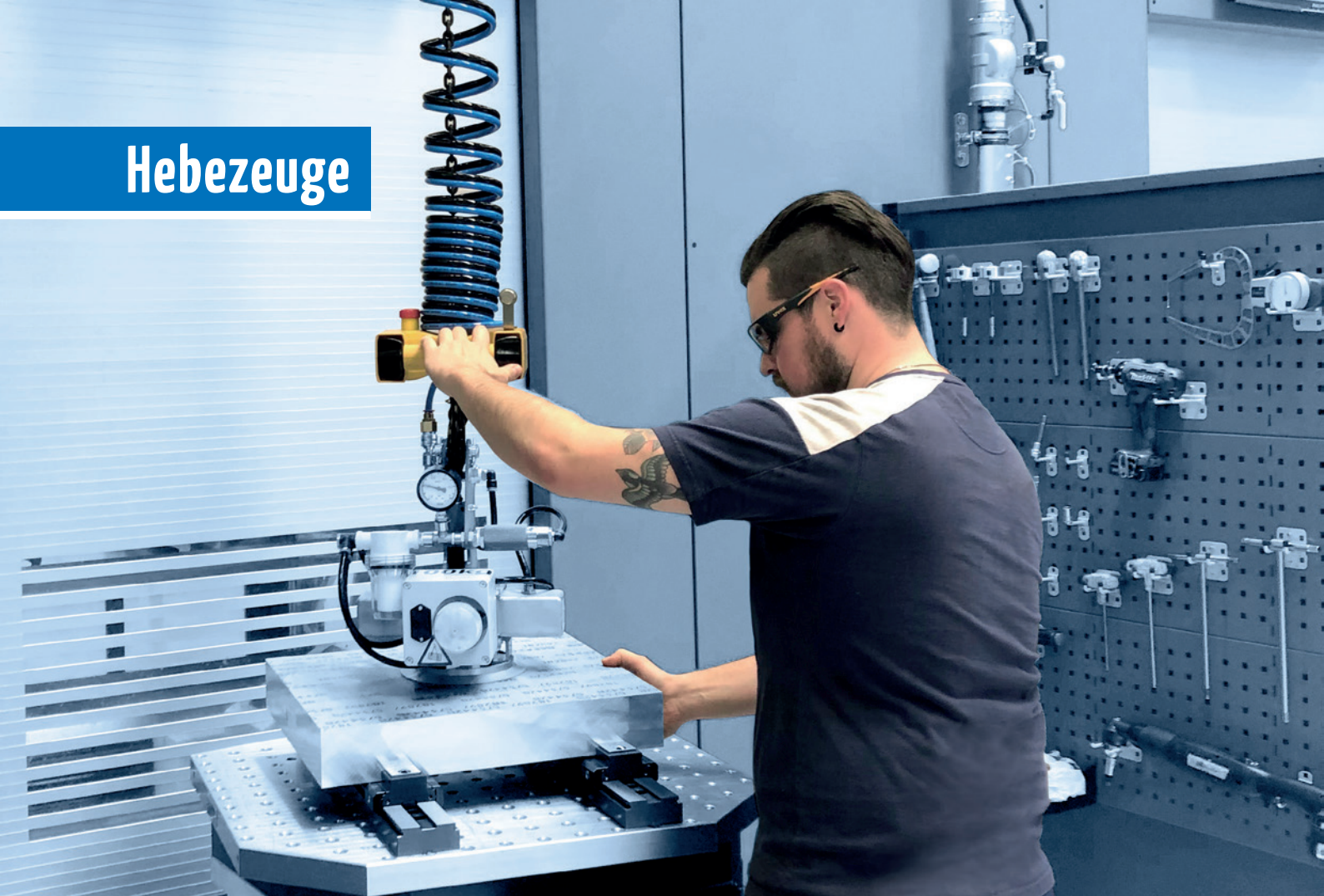
Der PLANETA Elektrokettenzug PEH-KH-LIFT mit Einhandbedienung
