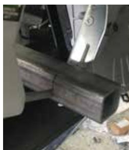
• Maximum cutting capacity 100 x 100 mm • SCHNITTKAPAZITÄT maxima 100 x 100 mm
