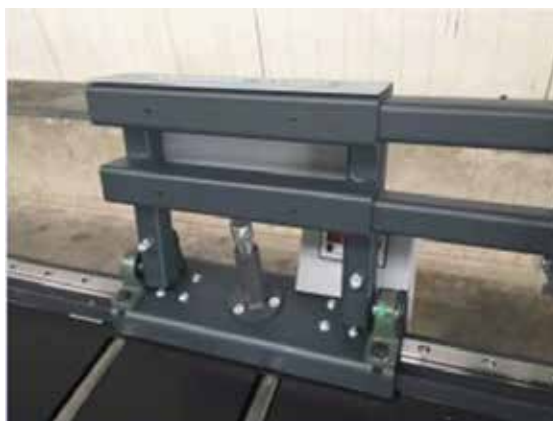
Manuell hochklappbarer Anschlag
