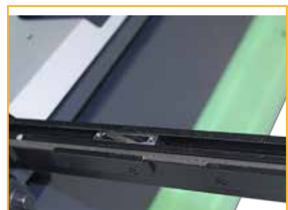
Der Ausrichtarm mit Lineal und Kippschlag an der Vorderseite der WKS-Schere ist Standard
