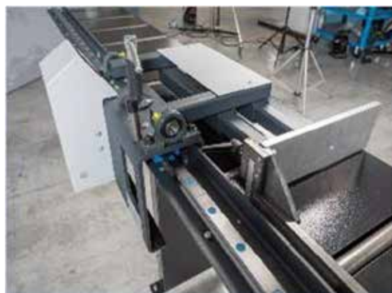
Anschlagwagen auf 30 mm Linearführungen
