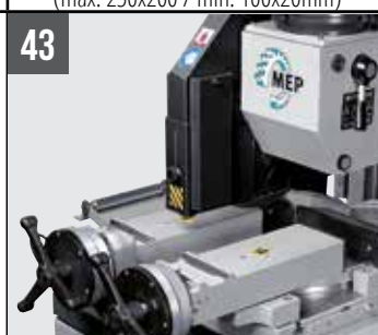
TIGER 352MA/SXevo/NC 5.0 TIGER 372 SXevo/CNC LR 4.0 Zusätzlicher, pneumatischer Schraubstock
