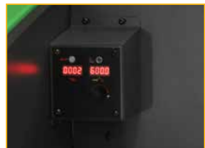
Einfache Einstellung / Programmierung für den Hinteranschlag
