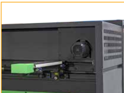
Hochpräziser, motorisierter Hinteranschlag mit einer Arbeitslänge bis zu 750 mm.
