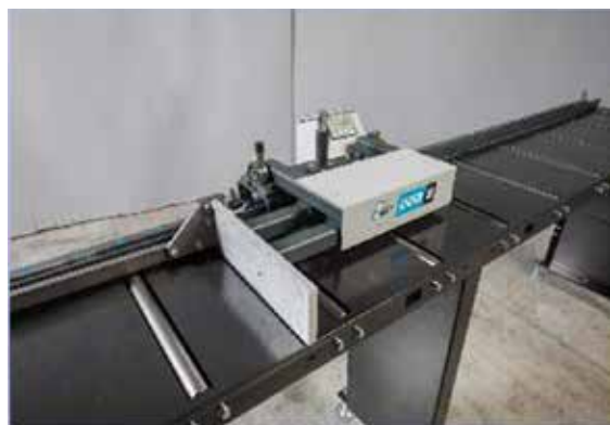
1000 mm Anschlagverlängerung zum Messen bis zum Werkzeug (optional)
