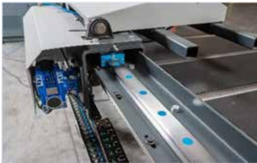
Anschlagwagen auf 45 mm Linearführungen
