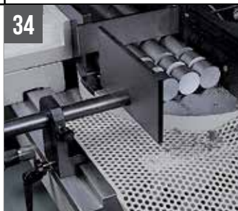
SHARK 331-1 NC 5.0 / 332-1 NC 5.0 Einstellbare Führung für das Entladen des abgesägten Stückes
