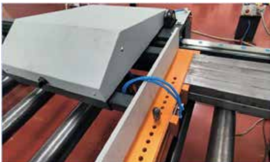
Pneumatischer Schraubstock mit max. Öffnung 500 mm (optional)
