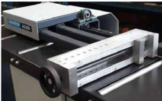
Manueller Schraubstock mit Handrad, max. Öffnung von 500 mm (optional)
