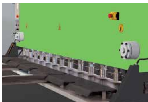
Optional: Fingerschutz an der Vorderseite mit Lichtschanke
